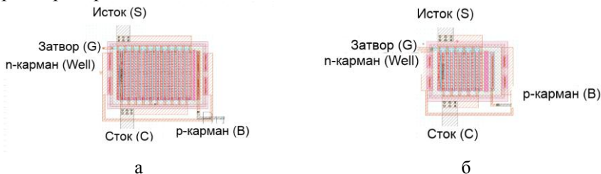
Рисунок 9 – Топологии разработанных RF-МОПТ с шириной канала 300 мкм (а) и 100 мкм (б)
