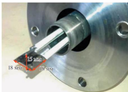
Рисунок 2.2 - Общий вид зонда Маха, установленного на токамаке Т-11М
