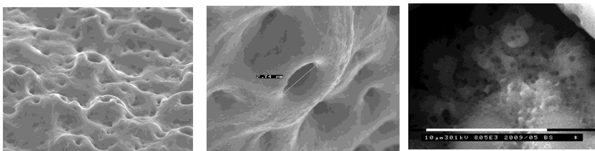
Рисунок 11 - Микрофотографии полимерного покрытия: а) рельеф поверхности покрытия, увеличение 600; б) рельеф поверхности покрытия, увеличение 3000; в) рельеф поверхности в поре, увеличение 8050
