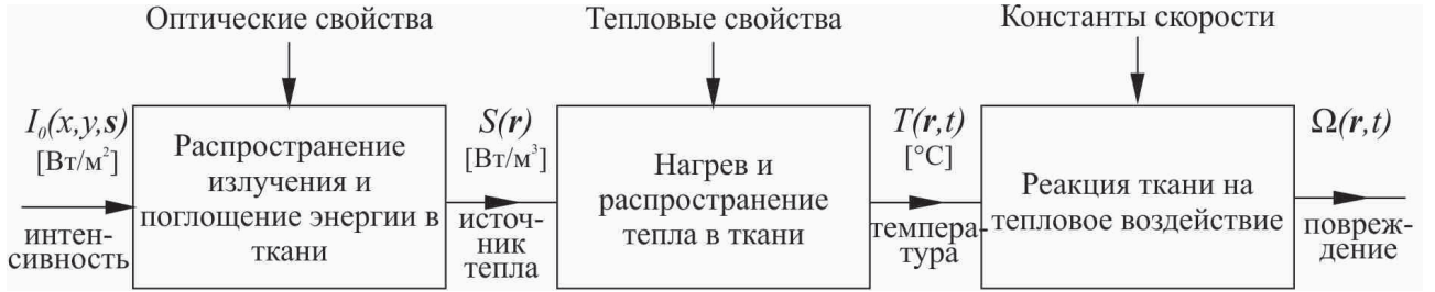
Рис. 1. Этапы оптико-тепловой модели лазерного воздействия на биоткань.
