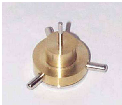
Рис. 10. Поглотитель механических колебаний для четвертьволнового сверхпроводящего резонатора.
