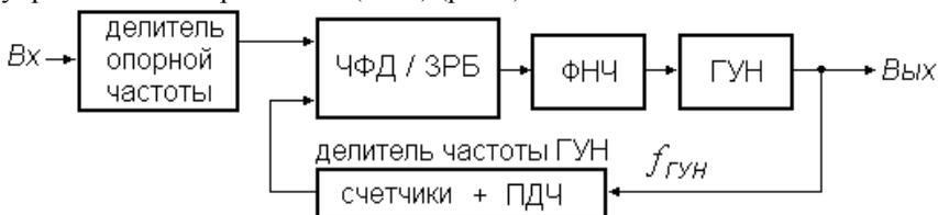
Рис.1. Упрощенная структурная схема целочисленного ФАПЧ-СЧ
