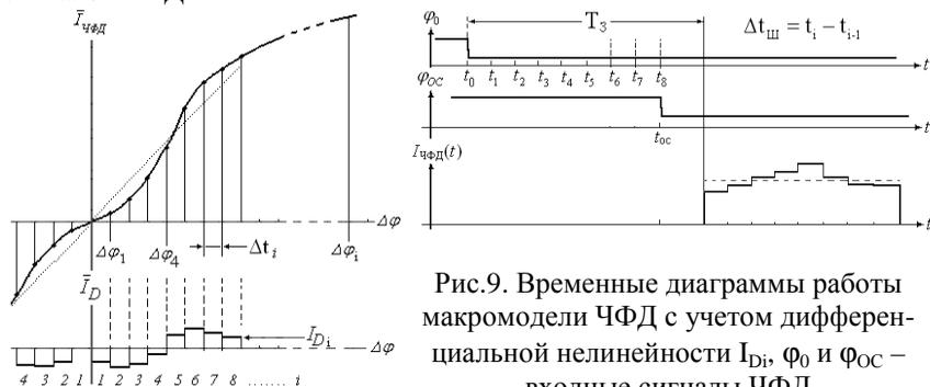
Рис.9. Временные диаграммы работы макромодели ЧФД с учетом дифференциальной нелинейности  $I_{D_i}$ ,  $\Phi_0$  и  $\Phi_{\text{OC}}$  - входные сигналы ЧФД
