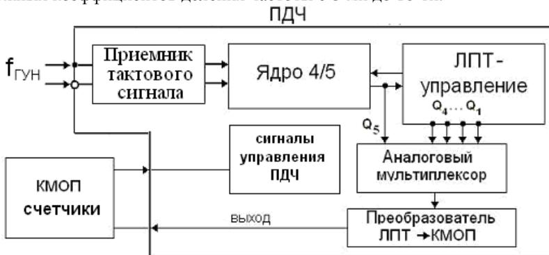
Рис.3. Структурная схема разработанного делителя частоты
