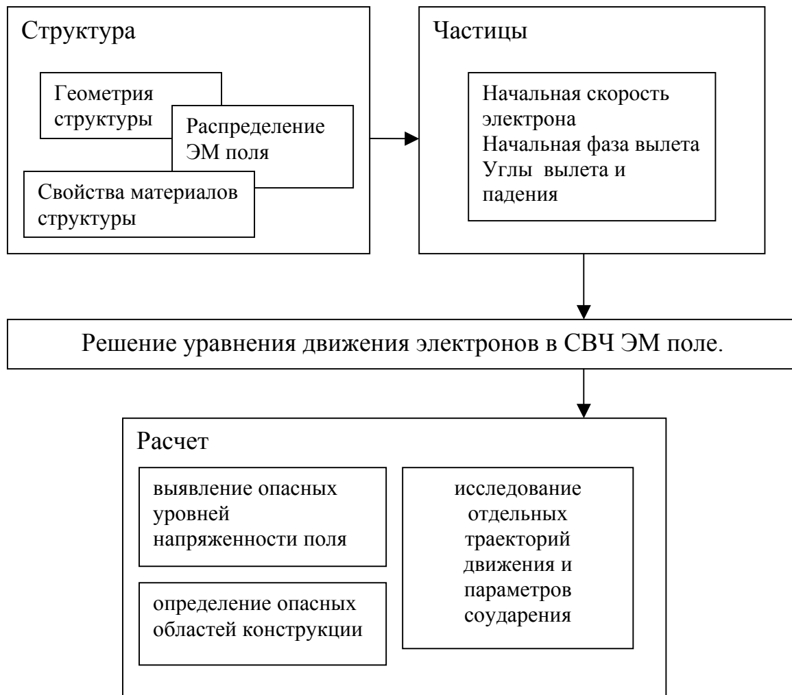
Рис.1. Схема методики расчета мультипакторного разряда в СВЧ устройствах ускорителей заряженных частиц.
