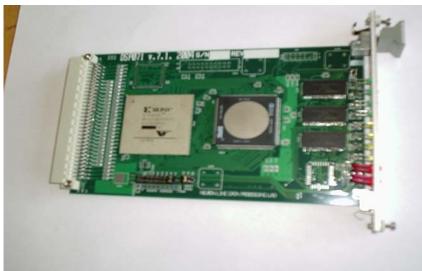
Рис.17. Внешний вид модуля сигнальной обработки
