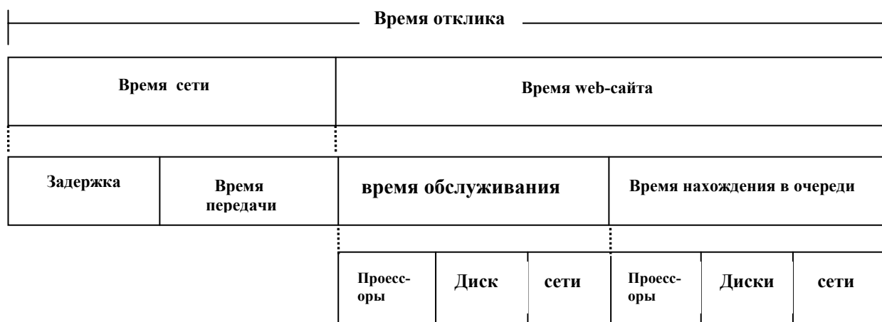
Рис 6. Составные части времени отклика
