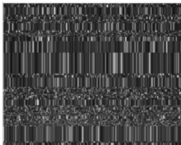
Рис. 2. Отказ системы адресации КМОП-матрицы
