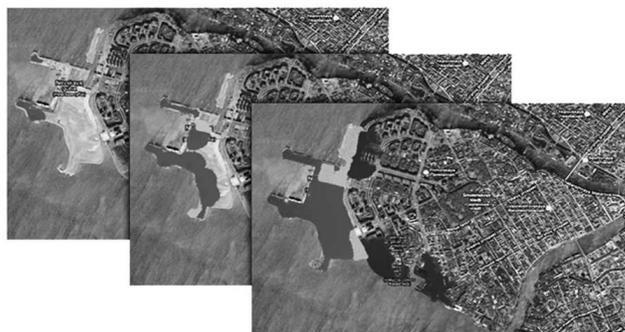
Рис. 16. Визуализация результатов расчета затоплений нагонной волной территорий Васильевского острова
