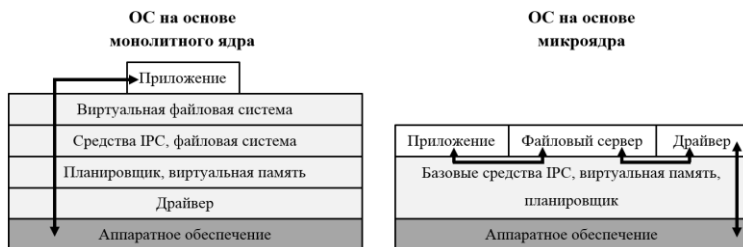
Рис. 1. Структура ОС, построенных на базе монолитного ядра и микроядра
