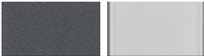
Рис. 1. Темновые изображения с ПЗС-матрицы КАИ-2093 в отсутствии света до (слева) и после (справа) воздействия гамма-излучения
