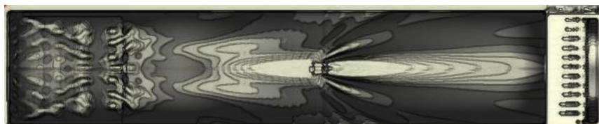
Рис. 1. Пример двухчастичного кластера самоподобных кубических элементов, формирующих фотонную струю с субволновым размером области фокусировки
