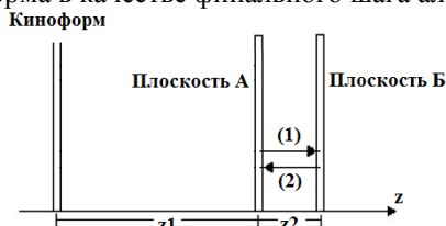
Рис. 1. Схема синтеза киноформов объемных сцен методом «пинг-понг»
