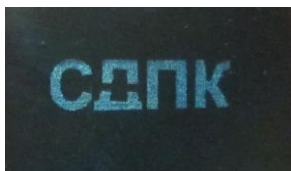
Рис. 2. Прямая лазерная запись на слое a-Si интерференционного фильтра
