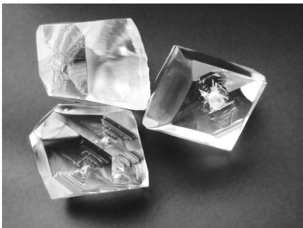
Рис. 1. Фотографии выращенных монокристаллов LBO массой от 400 до 500 г
