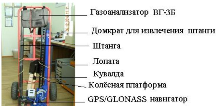
Рис.1 Измерительный полевой комплекс
