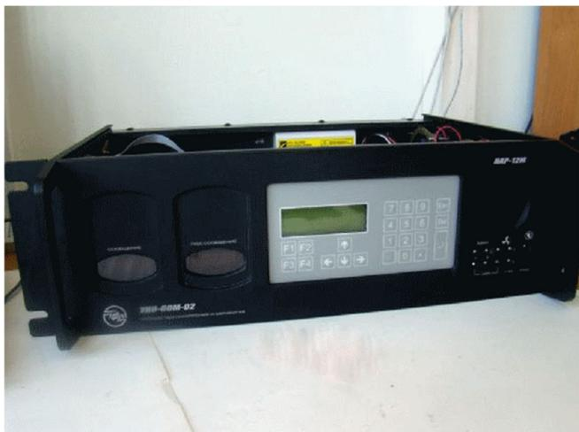
Рис. 1. Устройство накопления и обработки информации информационно-измерительной системы NAR-12M
