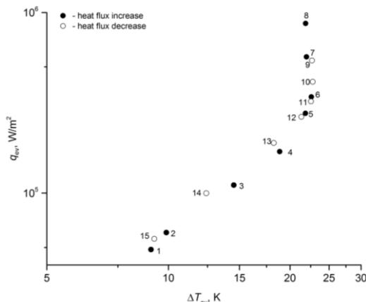
Рис. 1. Кривая кипения насыщенной воды при атмосферном давлении
