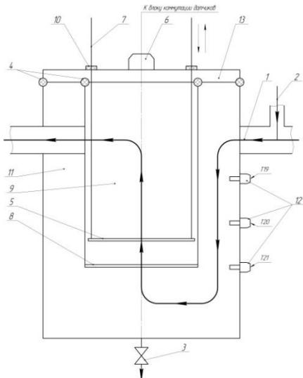
Рис. 1. Общий вид экспериментальной модели: 1 – основная петля циркуляции; 2 – вспомогательная петля циркуляции; 3 – вентиль осушения установки; 4 – уплотнение крышки модели; 5 – матрица датчиков; 6 – гермовод линий связи датчиков; 7 – кронштейны крепления матрицы датчиков; 8 – дырчатый лист; 9 – имитация активной зоны; 10 – контргайка; 11 – кольцевой зазор; 12 – датчики температуры кольцевого зазора; 13 – крышка
