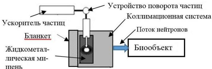
Рис. 1. Принципиальная схема ускорительно-управляемой системы для медицинских приложений
