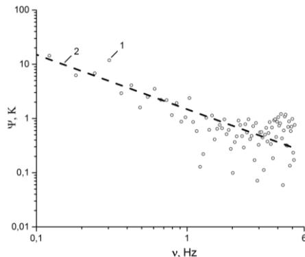
Рис. 2. Зависимость амплитуды флюктуаций от частоты для жидкого азота в области конвективной теплоотдачи: 1 – экспериментальные данные, 2 – аппроксимация функцией  $\Psi \sim \nu^{-1}$
