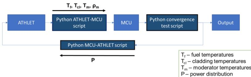
Рис. 1. Схема связанного нейтронно-физического/теплогидравлического расчета ТВС ВВЭР-1000
