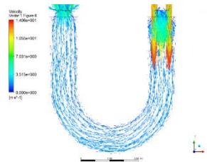
Рис. 2 - Схема движения теплоносителя при  $q_1 > q_2$
