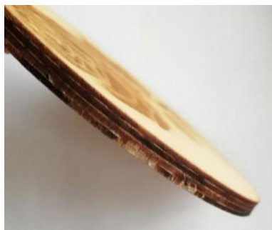
Рис. 6 – Не до конца прорезанный край детали
