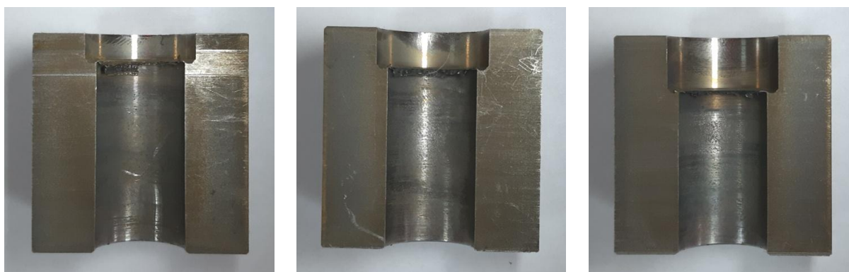
Рис. 4 – Зенкерование на глубину 5 мм, 7 мм, 10 мм
