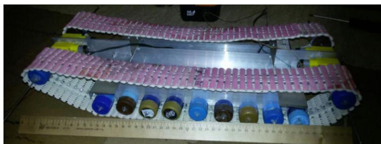
Изображение 3 – Рама с установленными мотор-редукторами и натянутыми гусеницами.
