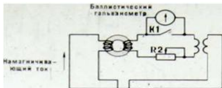
Рис. 1 – Схема баллистического метода
