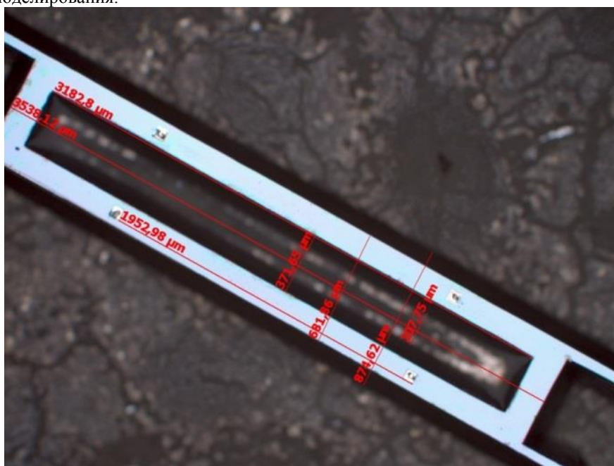
Рис. 9. Фотография 3D тензорамки чипа преобразователя МЭМС-КНИМТ с размерами
