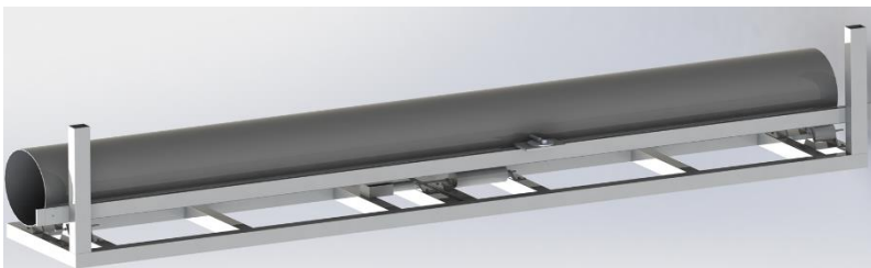
Рис.1. Внешний вид автоматизированного стенда для дефектоскопии при входном контроле магистральных труб
