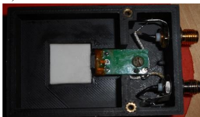
Рис.1. Атмосферный зонд формата CubeSat: а) 3D модель, б) сцинтиллятор, кремниевый фотоумножитель и стабилизаторы напряжения
