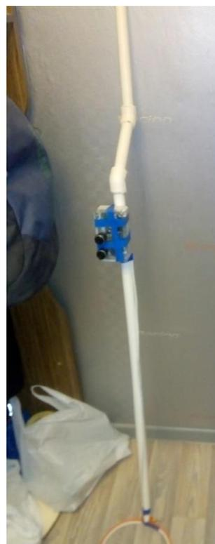
После включения питания, необходимо поднять металлоискатель над землей. Выставить переменный резистор в такое положение, что звука в не слышно. Опустить датчик металлоискателя к земле. Перемещать датчик нужно медленно и плавно, стараясь держать расстояние от земли до датчика одинаковым. При обнаружении металлических предметов на пути датчика, появляется звук.
