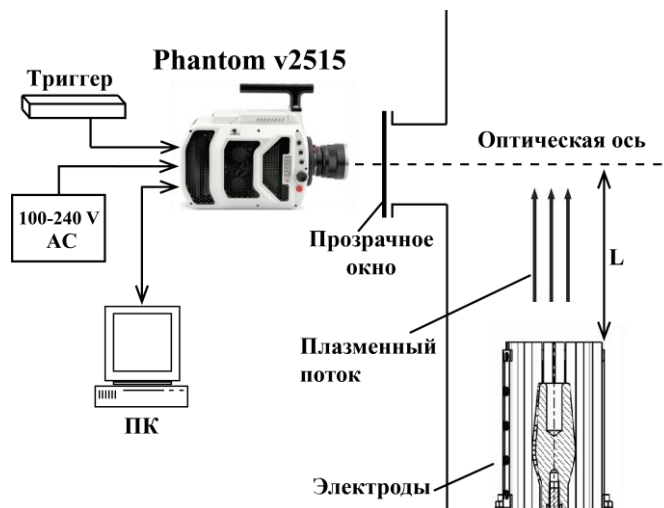
Рис.1. Схема диагностики с использованием скоростной видеокамеры Phantom v2512
