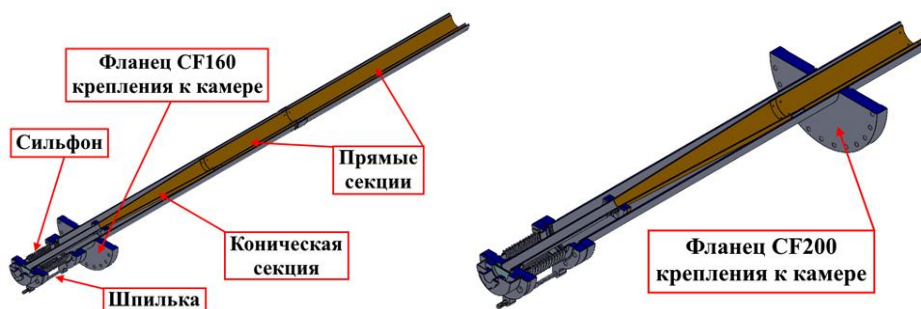
Рис. 2. Модели антенн для ввода и приема зондирующего излучения, расположенных в нижней (слева) и в верхней (справа) частях камеры
