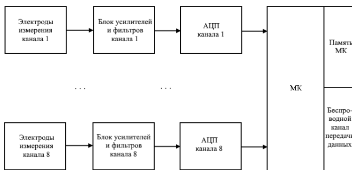
Рис. 1. Структурная схема нейроинтерфейса.
