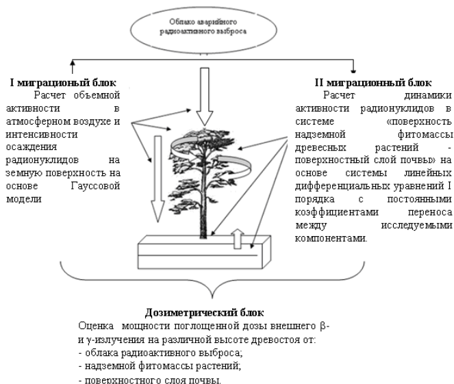
Рис. 1 Общая структура миграционно-дозиметрической модели для оценки дозы от гамма- и бета- излучения хвойных древесных растений при аварийных радиоактивных выпадениях
