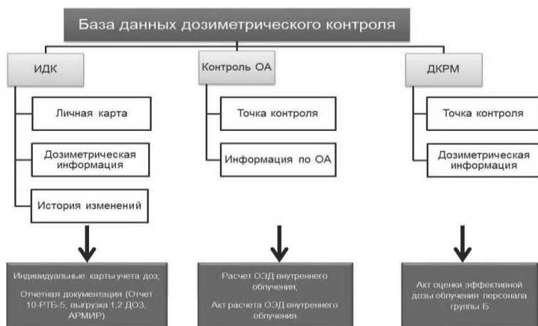
Рис. 1. Структурная схема базы данных дозиметрического контроля
