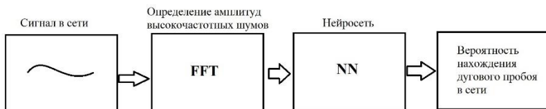
Рис. 1. Общая схема детекции дугового пробоя
