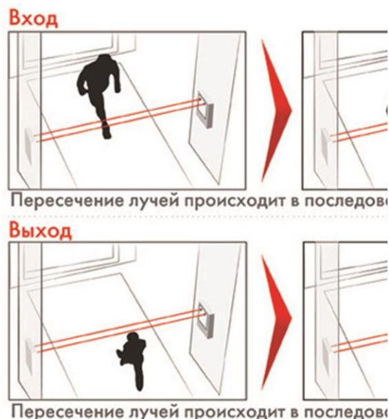
Основной вычислительный компонент системы здесь — компьютер, к которому инфракрасные датчики с применением специальных интерфейсов подают. Связь между датчиками и ПК может быть проводной или беспроводной — с использованием Wi-Fi. Работать датчики могут от сети или от батареи. Есть у ИК-датчиков и недостатки. Прежде всего — это не самая высокая точность измерений.
