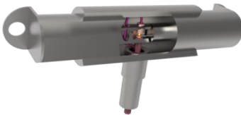
Рис. 2. 3D-модель ВОДФ аттенуаторного типа
