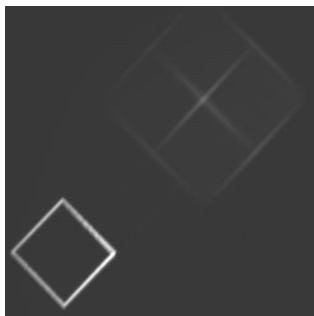
Рис. 1. Вид сигнала в выходной плоскости коррелятора в случае совпадения объектов
