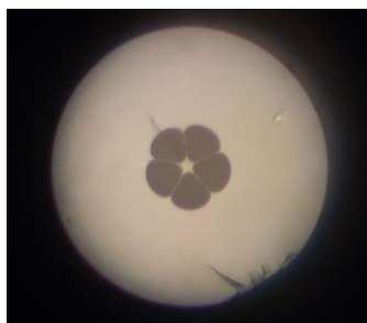
Рис. 1. Фотография микроструктурированного ОВ с синтетической сердцевиной
