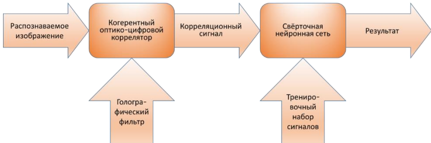
Рис. 1. Блок-схема оптико-цифрового коррелятора с нейросетевой обработкой выходных сигналов
