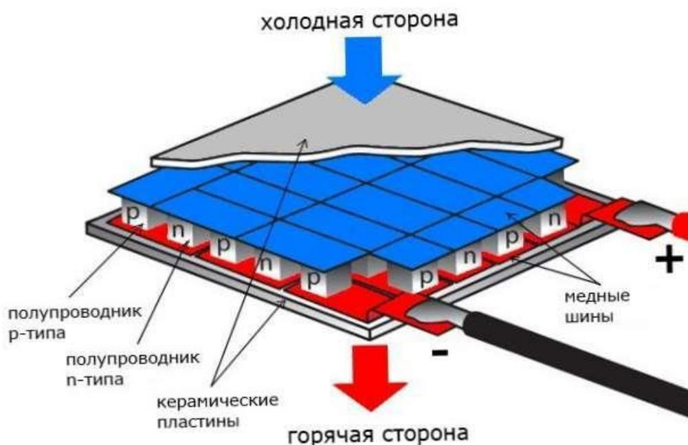
Рисунок.2 -Устройство элемента Пельтье.
