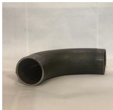
Рис. 8.1, 8.2. Результаты гибки трубы диаметром 57 мм
