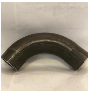
Рис. 8.1, 8.2. Результаты гибки трубы диаметром 57 мм
