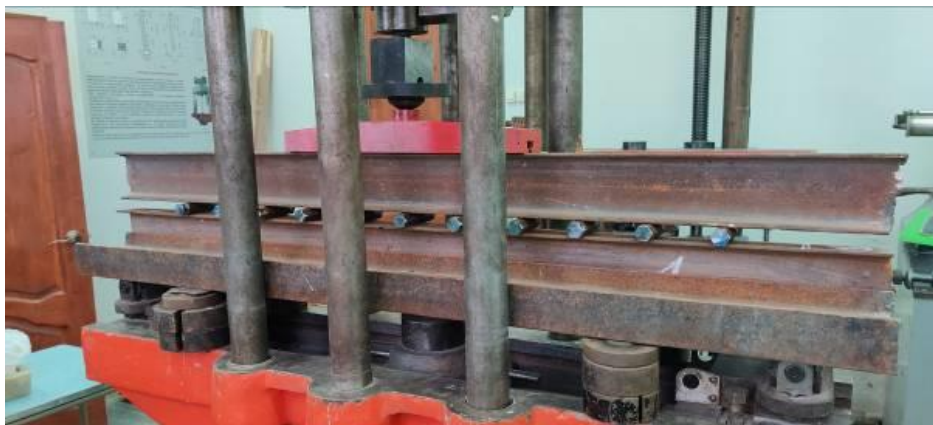
Фото 2. Испытательный стенд с металлической балкой, усиленной углеволокном
