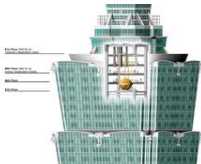
Рис. 8. Конструктивная схема инерционно – маятникового гасителя колебаний
