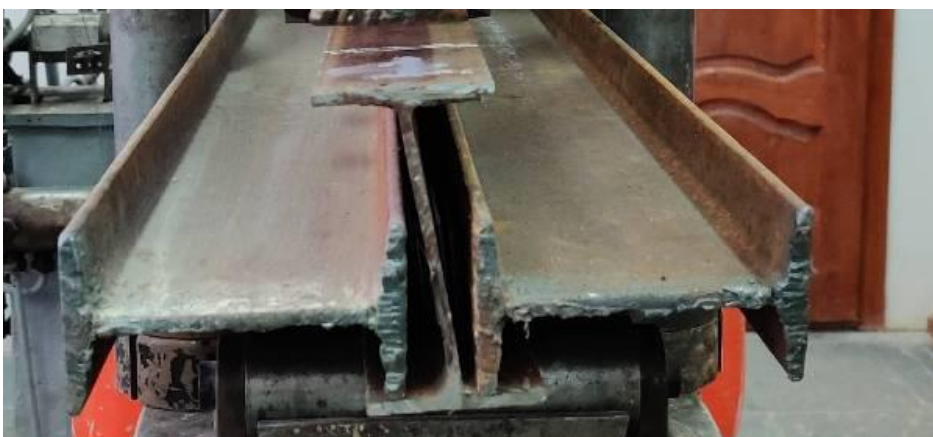
Фото 3. Испытательный стенд с испытанной балкой, усиленной углеволокном
