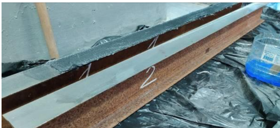
Фото 1. Образцы металлических балок: 1 - усиленная углеволокном; 2 - неусиленная
