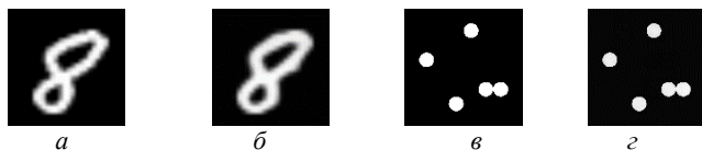
Рис. 1. Примеры оригиналов объектов (а, в) и восстановленных изображений с применением генеративно-состязательной нейросети (б, г)
