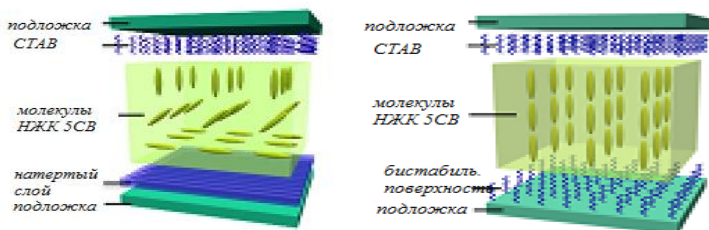
Рис. 1. Схема геометрии ячейки с гибридной (слева) и гомеотропной (справа) ориентации
