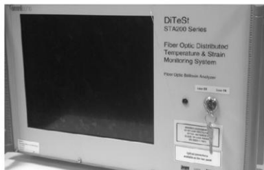
Рис. 1. Оптоэлектронный датчик распределенной сенсорной системы Бриллюэна
