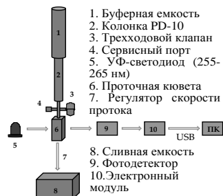
Рис. 1. Схема оптического сенсора
