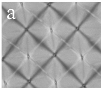
Рис. 1. Вид двумерного фотонного кристалла в проходящем свете
