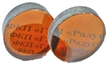
Рис. 2. Образец высокопрозрачная композитная лазерная керамика (ВПКЛК) Nd:YAG/Cr:YAG
