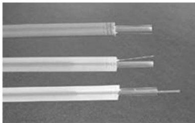
Рис. 2. Волоконные датчики температуры и деформации
