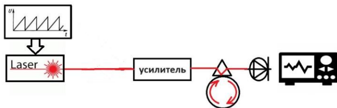
Рис. 1. Схема экспериментальной установки для измерения сдвигов частоты
