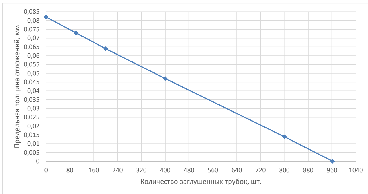
Рис. 3. Зависимость предельной толщины отложений от количества заглушенных трубок для теплообменника аварийно-планового расхолаживания без интенсификаторов теплообмена
