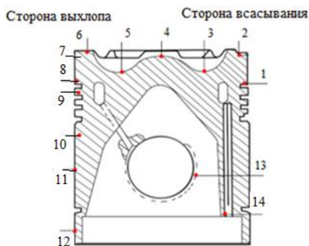
Рис. 1. Эскиз поршня с точками замера температур
