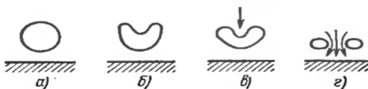
Рис. 1. Схема захлопывания кавитационных пузырьков с образованием микроструй: а) исходный сферический пузырек; б) сплющивание со стороны высокого давления; в) образование углубления; г) возникновение высокоскоростных микроструй жидкости.
