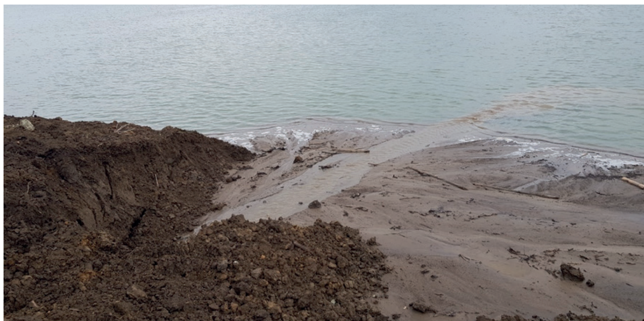
Рисунок 4. Механическая суффозия на ПК160 - ПК180 профиля № 1
