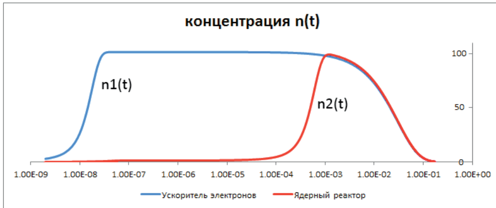
Рис. 3. Зависимость концентрации поверхностных состояний от времени (расчёт) при облучении на ускорителе электронов 1 (синяя кривая, n_1 ) и ядерном реакторе (красная кривая, n_2 ); \tau = 10 мс
