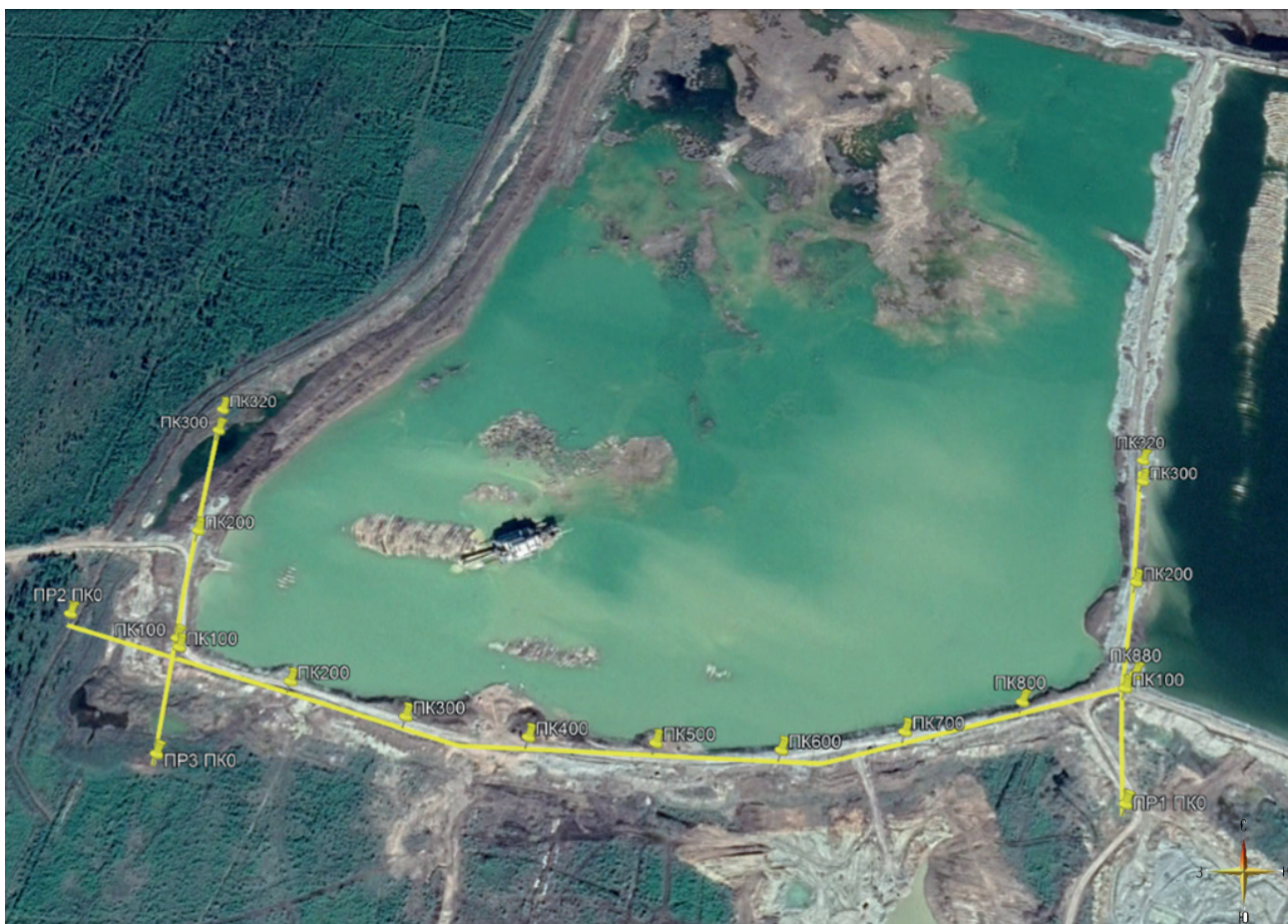
Рисунок 1. Схема расположения геофизических профилей на дамбах котлована № 6 (спутниковый снимок)
