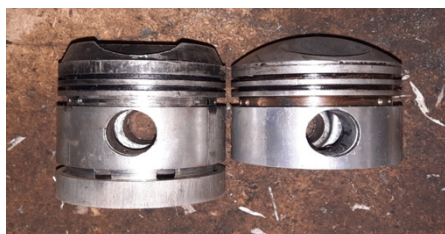
Рисунок 3 – Внешний вид стандартного и доработанного поршней
