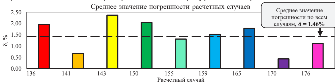
Рис. 4. Значения средней погрешности расчетных случаев и значение средней погрешности по расчетным случаям
