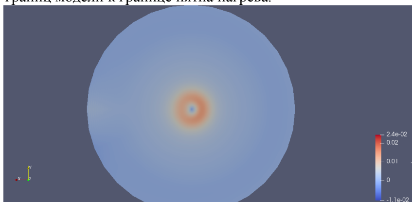
Рисунок 3. Горизонтальный срез радиальной скорости через 24 секунды нагрева на высоте 0.1.
