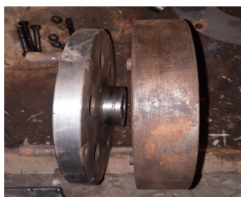
Рисунок 2 – Внешний вид доработанного и стандартного маховиков
