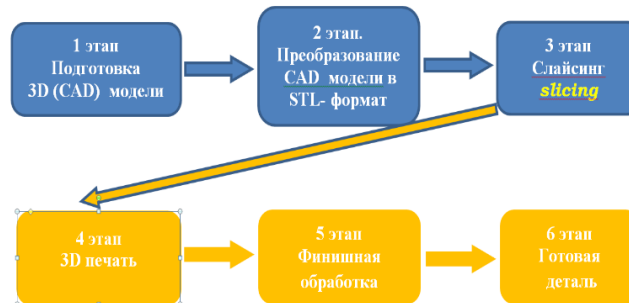
Рисунок 1- Схема SLM технологии [1]
