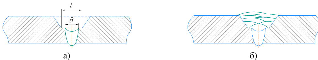
Рисунок 2 – Схема выполнения сварного шва
