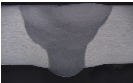
Рисунок 3 – Поперечное сечение сварного соединения
