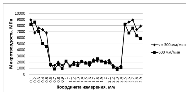
Рис. 2. Распределение микротвердости в участках плазменного покрытия из бронзы ПГ-19М-01
