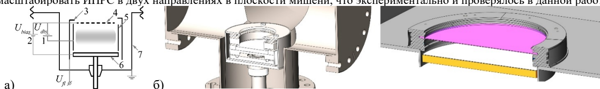
Рис. 1. а) Электрическая схема распылительной системы на основе асимметричного разряда с полым катодом: 1 – блок питания РПК, 2 блок питания смещения сеточного катода, 3 – изолированный экран, 4 – сетка (катод), 5 – анод, 6 – мишень (катод), 7 – камера вакуумного стенда; б) Сечение моделей двух экспериментальных распылительных систем в корпусах вакуумных стендов (Площади мишеней: 79 см 2 – слева, 1018 см 2 – справа; картинка в масштабе).
