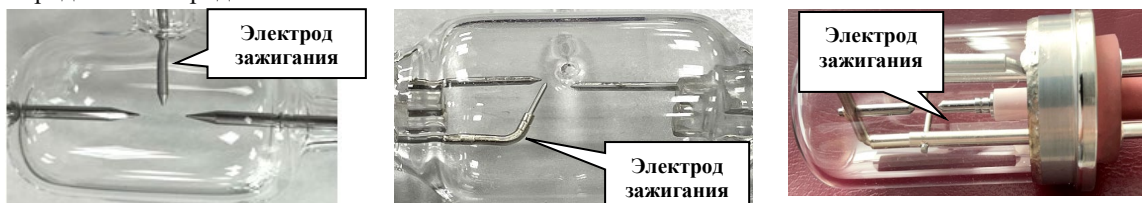
Рис. 1. Разработанные варианты конструкции многоэлектродных ламп с кварцевой оболочкой
