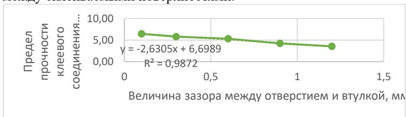
**Рис. 3 – Зависимость предела прочности клеевого соединения от величины зазора**
