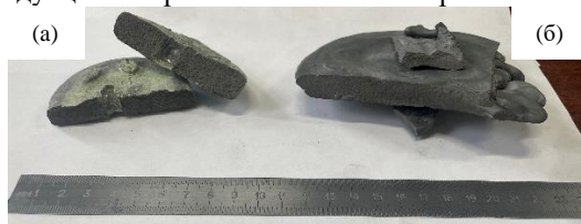
Рисунок 2 – внешний вид образцов Dy (а) - после процесса восстановления Ca-термии и (б) - после рафинирующего вакуумно-дугового переплава.
