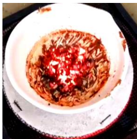
Рис. 1. Горение ксерогеля с янтарной кислотой
