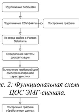
Рис. 2: Функциональная схема ЦОС ЭМГ-сигнала.
