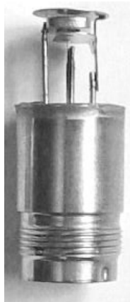
Рисунок 2. Датчик давления. Рисунок 3. Осциллограмма напряжения с датчика давления.
