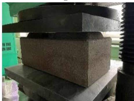
Рис. 3. Испытание материалов: 1 – красный кирпич; 2 – силикатный кирпич; 3 – шлакоблок; 4 – лего-блок
