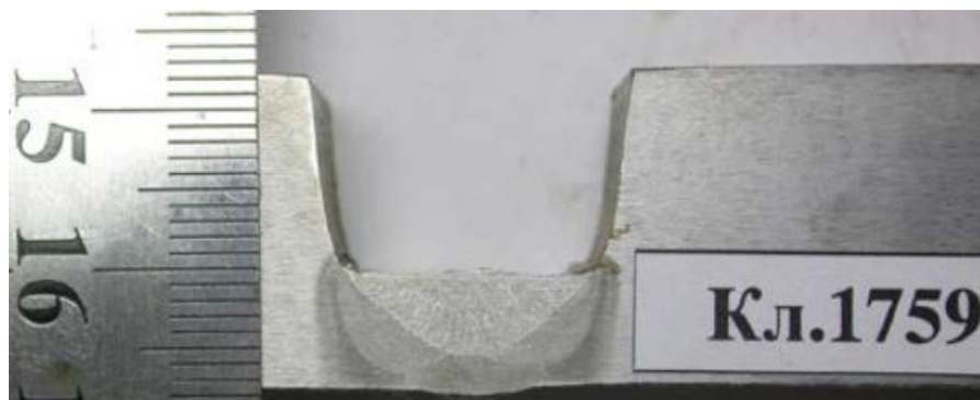
Рис. 3. Образец для исследования макроструктуры проба 1П
