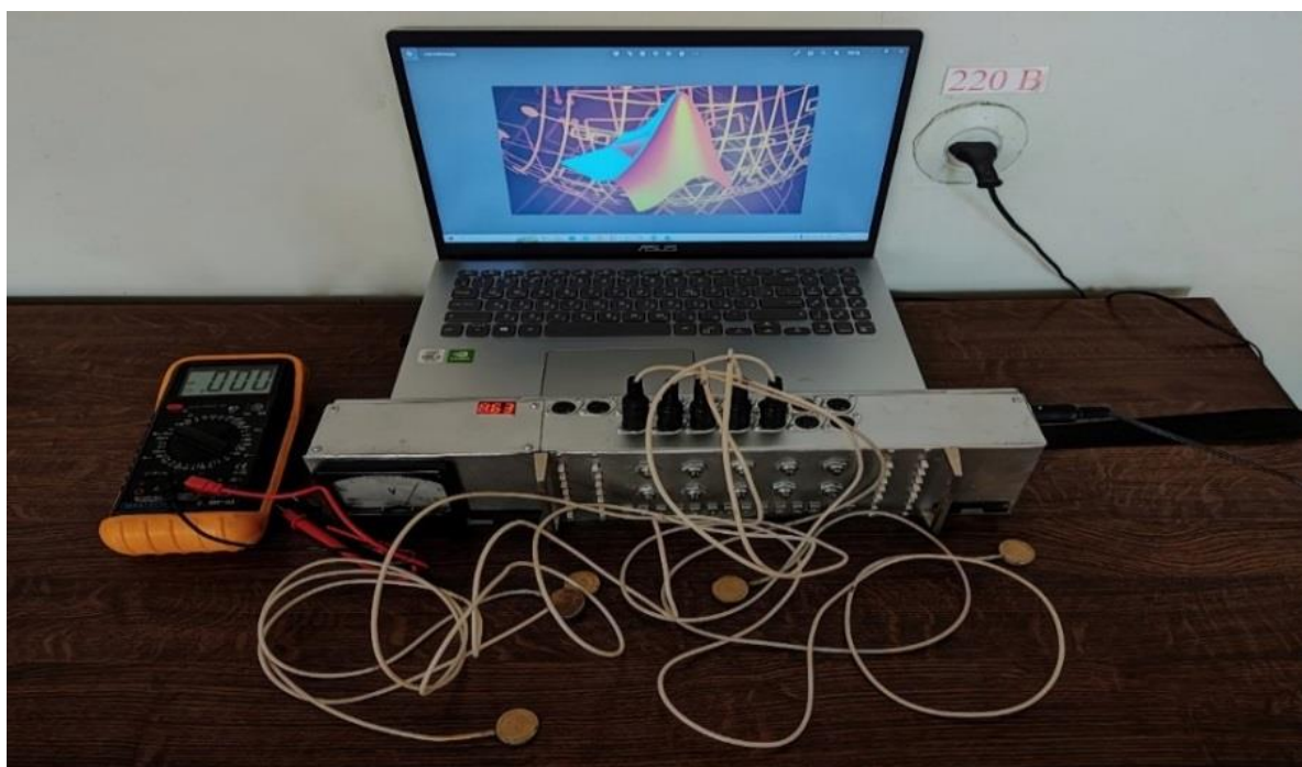
Рис. 2. Внешний вид цифровой системы мониторинга и датчиков для измерения НДС исследуемого грунтового основания
