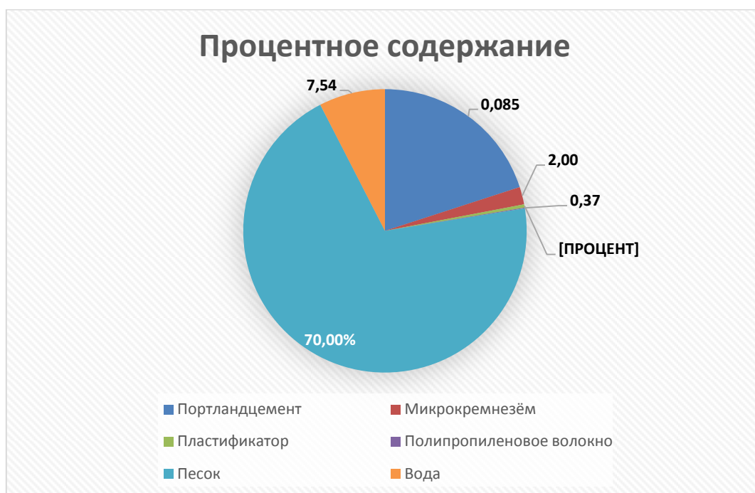
Рис. 3. Процентное содержание компонентов в бетоне с волокнистой фиброй
