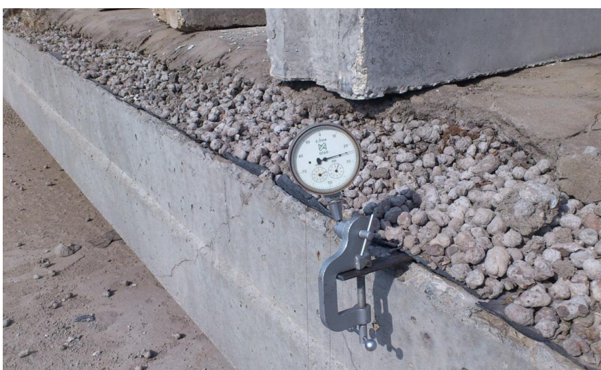
Рис. 3. Схема измерения прогибов плиты в ходе испытания
