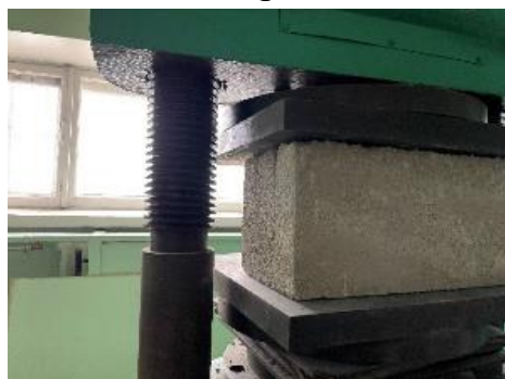
Рис. 3. Испытание материалов: 1 – красный кирпич; 2 – силикатный кирпич; 3 – шлакоблок; 4 – лего-блок
