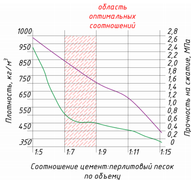
Рис. 1. Влияние соотношения «цемент – перлитовый песок» на физические свойства цементного камня
