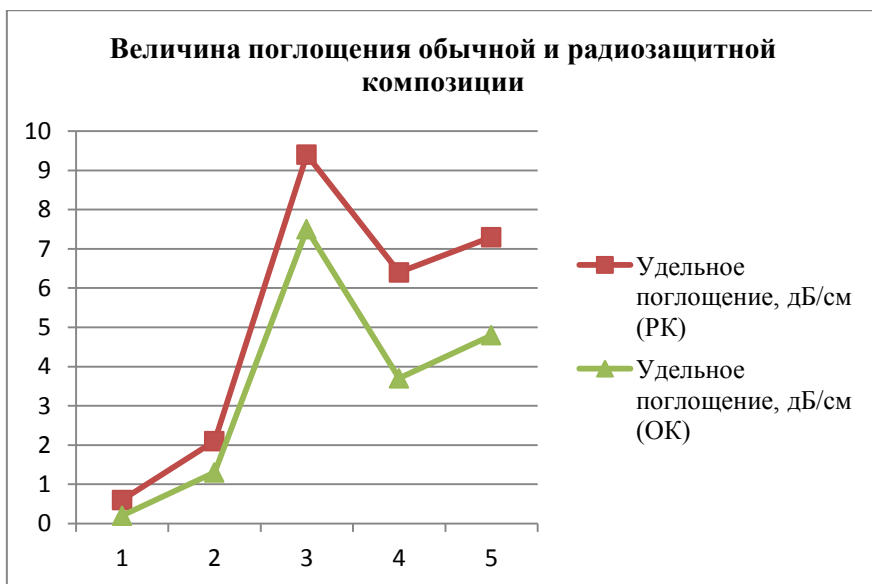
Рис. 6. Сравнение обычной и радиозащитной композиции по величине удельного поглощения радионуклидов
