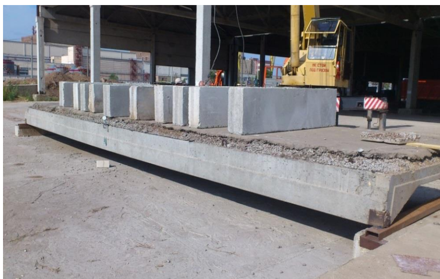
Рис. 2. Последовательность загрузки плиты
