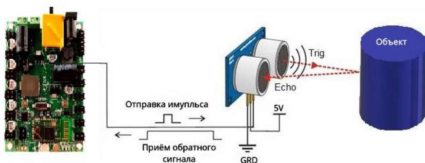
Рис. 2. Схема работы датчика HC-SR04
