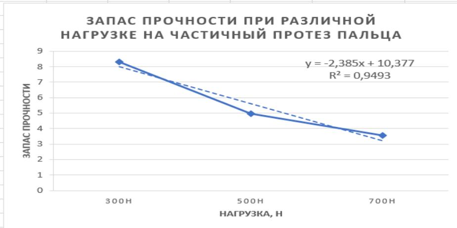
Рис. 8. Зависимость запаса прочности от нагрузки на частичный протез пальца из ABS пластика
