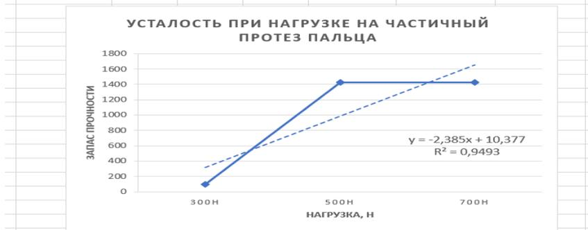
Рис. 12. Зависимость запаса прочности от нагрузки на частичный протез пальца из ABS пластика
