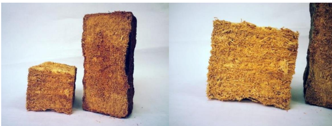
Рисунок 2 – Пробные тела из мицелиального композита
