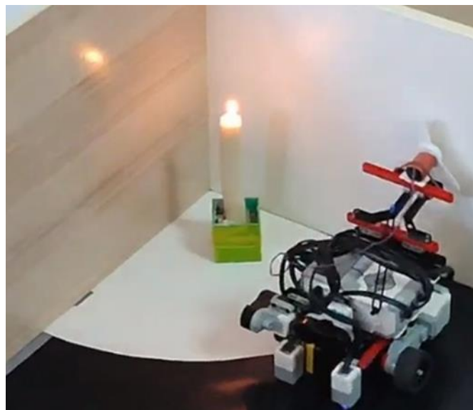
Рисунок 5 – Прототип робота для тушения возгорания на основе конструктора LEGO Mindstorms
