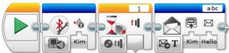
Рисунок 4 - Подключение связи управления по технологии Bluetooth
