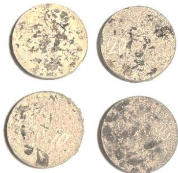
Рис. 1. Образцы из галлуазита с различным содержанием металлических отходов
