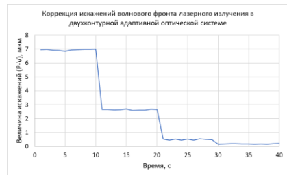
Рис. 2. Динамика изменения величины искажений в двухконтурной адаптивной оптической системе
