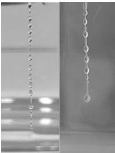
Рис. 1. Процесс образования капель травителя на поверхности ОВ: слева – конец волокна находится в объёме травителя, справа – конец волокна находится в воздушной среде
