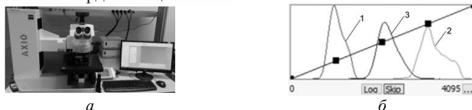
Рис. 1. Оптический микроскоп Zeiss Axio Imager Z.2 Vario (а), система настройки изображения: кривые для красного (1), зелёного (2) и для синего (3) цветов (б)
