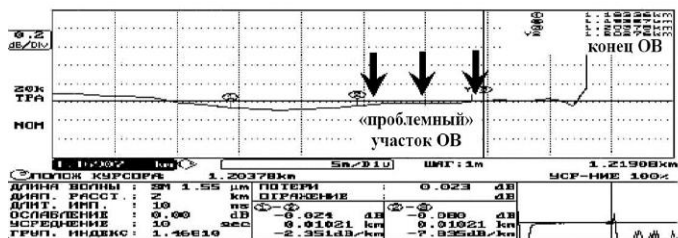
Рис. 1. Рефлектограмма OTDR для «проблемного» участка
