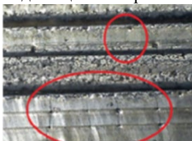
Рис. 1 Трещины в поверхностном слое лопатки (ИЧХ) после лазерной заделки
