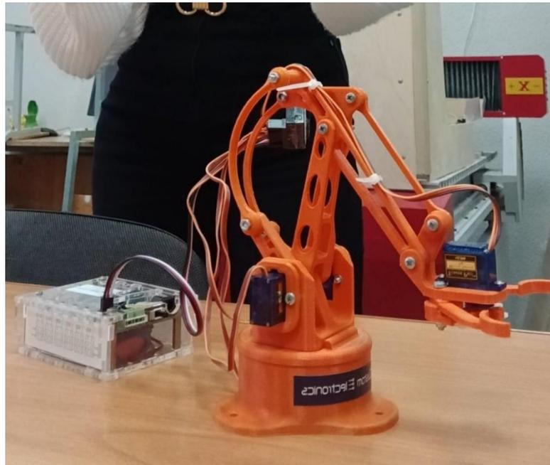
Рисунок 4 – Готовый прототип манипулятора
