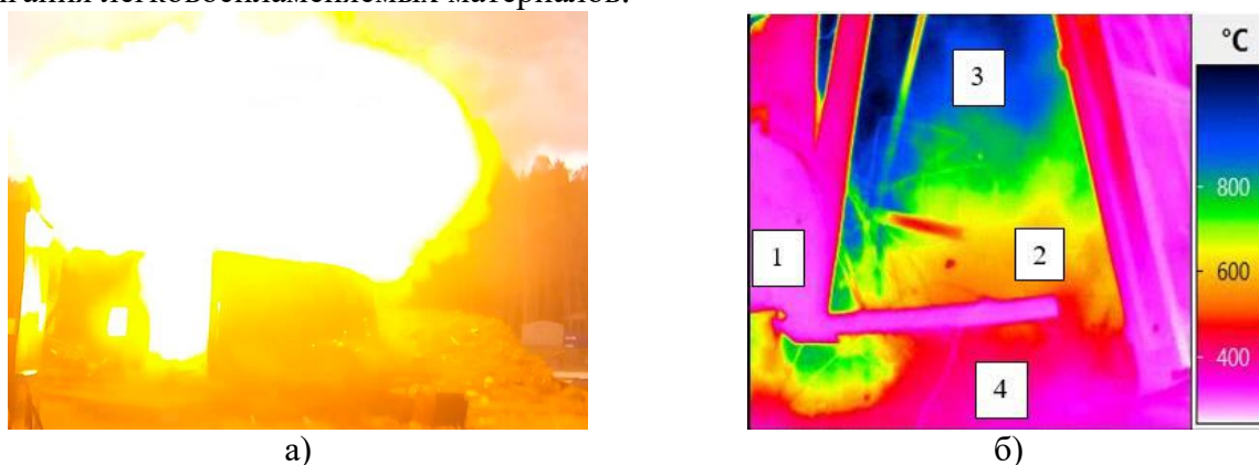
Рисунок 2 – Кадры огненного шара при взрыве баллона БМК: а) видеокамера, б) ИК камера. 1 – стенка пожарного стенда, 2 – баллон БМК, 3 – пламя, 4 – взвесь
