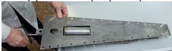
Рисунок 5 – Приемное диверторное устройство с подвижным модулем в сборе
