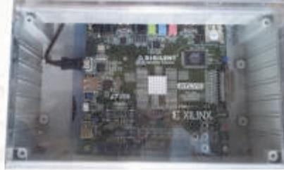
*Стенд на основе отладочной платы Atlys™ Spartan-6 FPGA Development Board*
