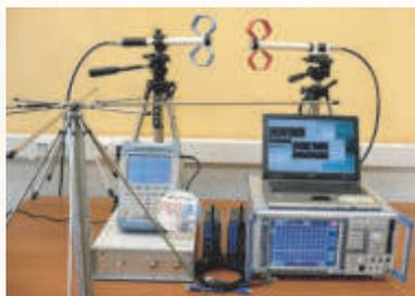
*Система «Стентор» для измерений действующих высот случайных антенн и коэффициентов реального затухания электромагнитных сигналов по магнитному и электрическим полям и в произвольных линиях*
