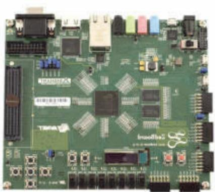
*Отладочный стенд на базе системы на кристалле Xilinx Zynq 7000*
