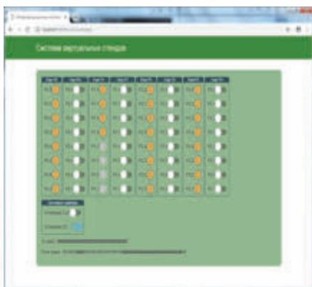
*Виртуальный стенд для выполнения лабораторных работ по курсу «Микропроцессорные устройства и системы». Обеспечивает наглядное тестовое окружение для процессорного ядра, реализованного на FPGA. Предназначен для локального и удаленного выполнения лабораторных работ. Автор А.И. Стрелец*
