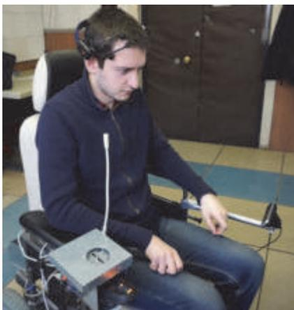
*Пример управления роботизированным инвалидным креслом с помощью жестов и ВСІ-интерфейса*
