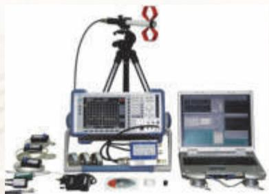
*Система «Сигурд» для исследований защищённости технических средств от утечки информации по каналу побочных электромагнитных излучений и наводок (ПЭМИН)*
