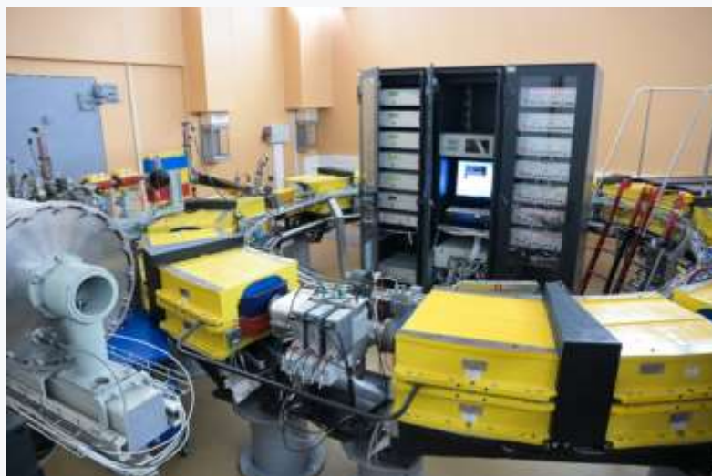
Циклотрон «Прометеус» вырабатывает протоны, которые используют при лучевой терапии
